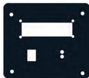
پوشش بالای ربات (محل نصب LCD و، کلید و LED
