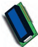
LCD کاراکتری برای نمایش اطلاعاتی مانند فاصله
